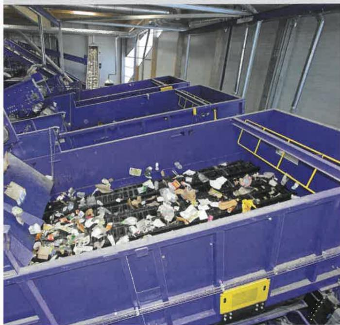
Aktid développe ses propres séparateurs balistiques qui offrent, grâce à leur grande surface, au design spécifique de leurs lattes et à leur amplitude de mouvement, un excellent niveau de séparation et une grande souplesse d'exploitation.
