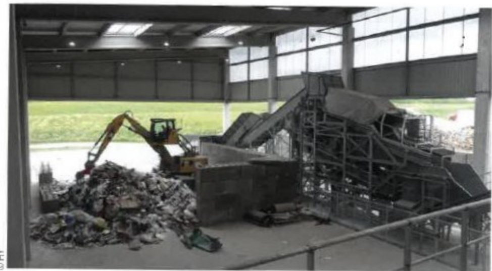
Point névralgique du process, le crible vibrant mesure 10 m de long pour 1,5 m de large.
