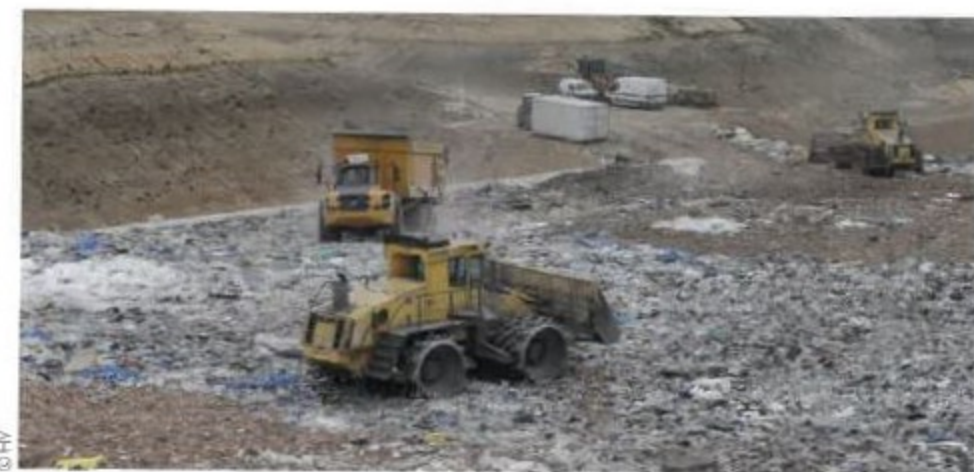
Le centre de stockage est exploité avec une chargeuse sur chenilles Caterpillar, un compacteur à déchets Bomag et deux tombereaux Volvo A40 dont les bennes ont été spécialement modifiées.
