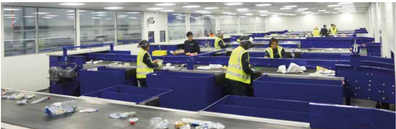
Après le tri optique, une dernière étape de contrôle qualité est réalisée dans la grande cabine de tri qui rassemble les agents de pré-tri et de contrôle qualité, au nombre de vingt-deux.
